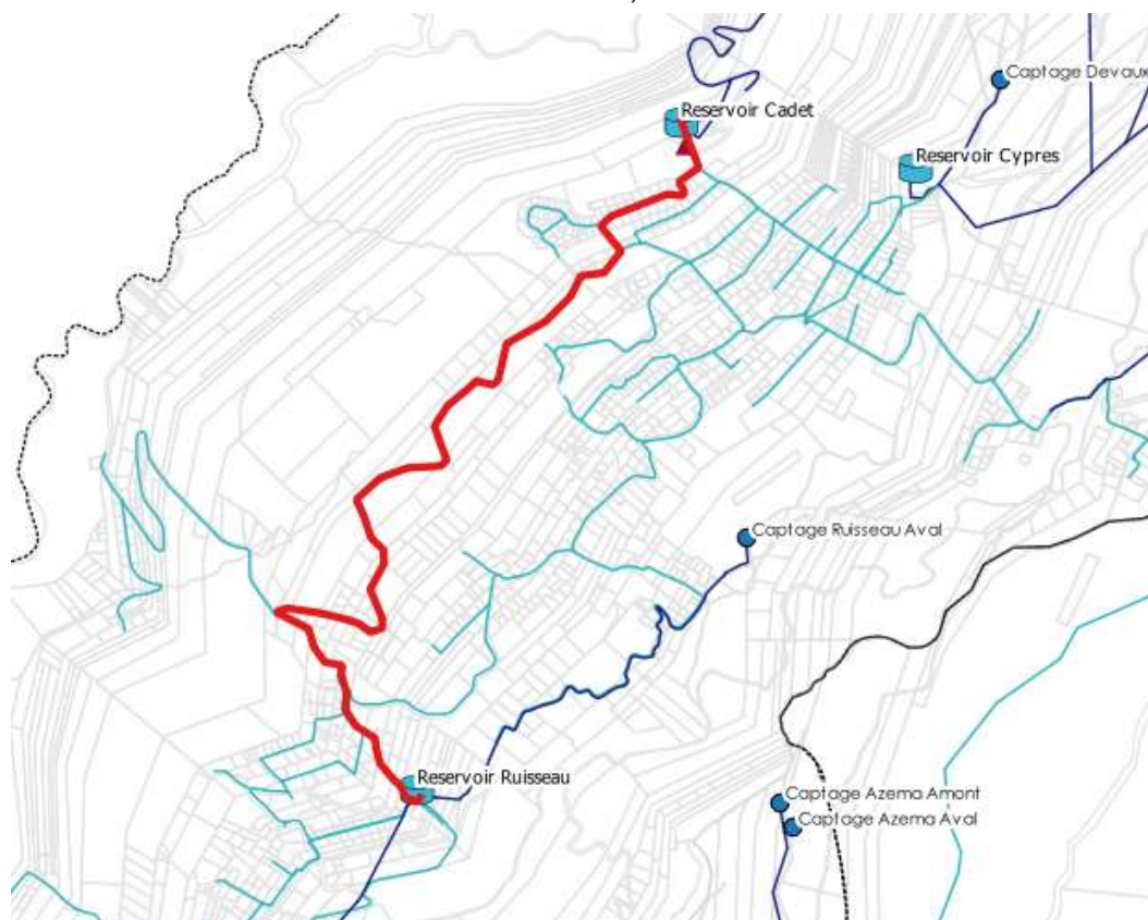
Figure 3-1 : Tracé envisageable du raccordement intra-communal des Avirons (alimentation des Hauts de la commune)
