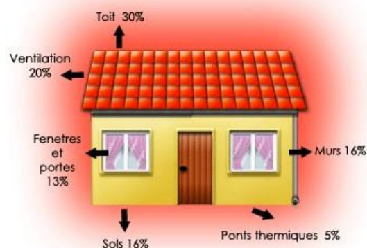
Figure 153 : Déperdition de chaleur d'un habitat non isolé
