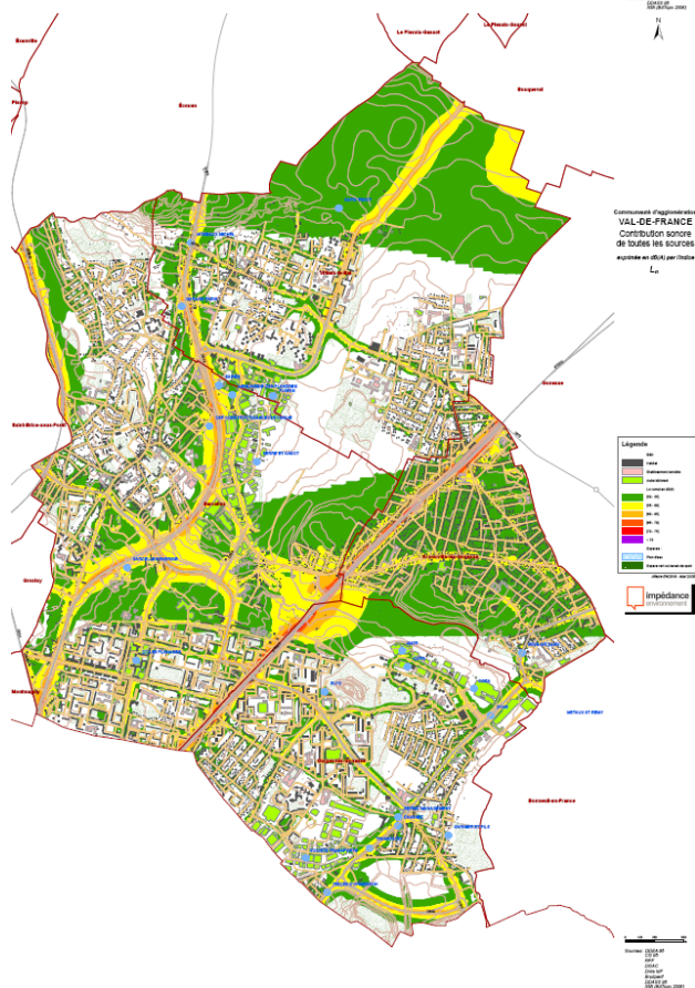
Figure 12 : Exemple des niveaux sonores nocturnes L_n générés par les quatre familles de sources cumulées (routes, fer, avions, ICPE-A+TC2) en situation actuelle
