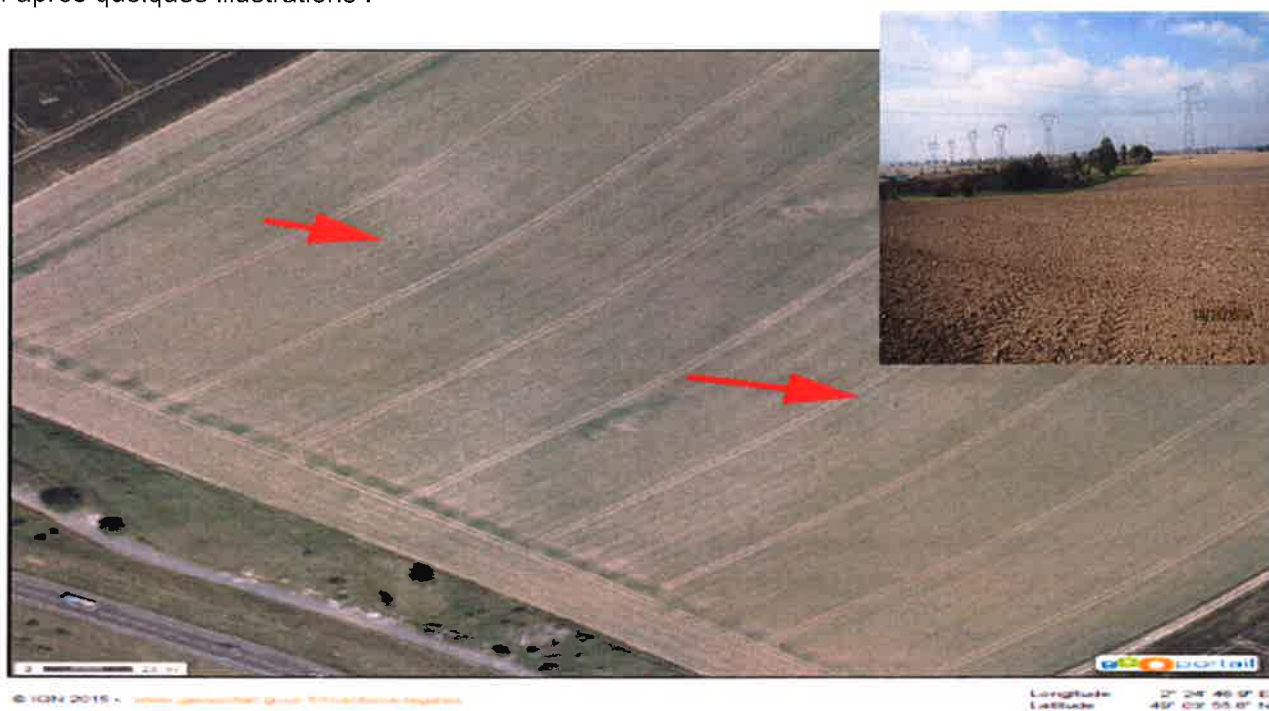
Figure 11: cliché de 2015 (Géoportail): champ longeant l'autoroute A104 (Sud de la commune de Mareil-en-France, lieu dit « La Jonchère ») : indices de fontis (environ 2 m de diamètre) ?
