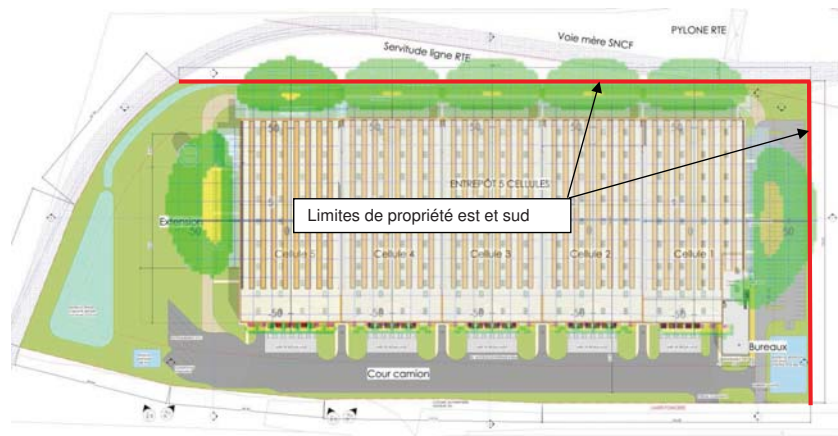
Figure 12 : flux thermiques – incendie d'une cellule 1510 avec MMR
