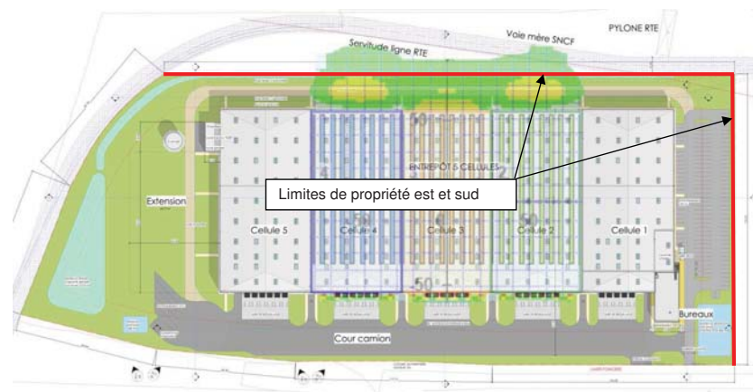
Figure 16 : flux thermiques – incendie généralisé de 3 vers 2 et 4
