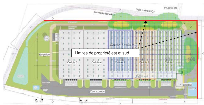
Figure 15 : flux thermiques – incendie généralisé de 2 vers 1 et 3
