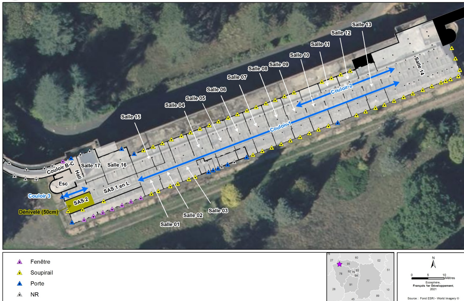
Carte 9. Présentation des ouvertures du bâtiment B
