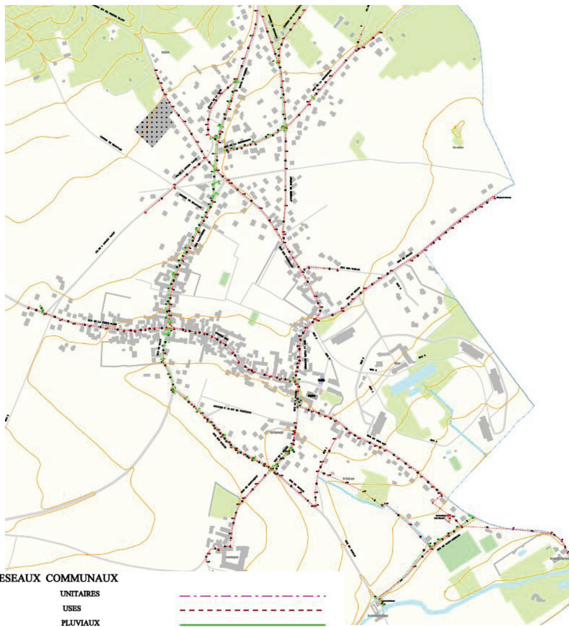
Plan du réseau des eaux pluviales et des eaux usées sur le village de Soisy-sur-Ecole.
