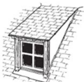
lucarne rampante ou en chien couché
