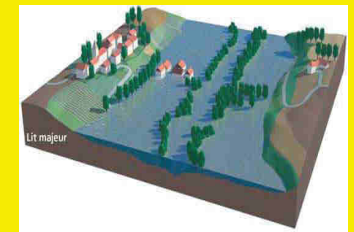
lit majeur du cours d'eau
