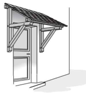
auvent de porte d'entrée
