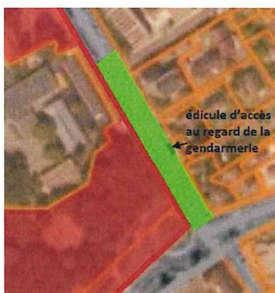
Détail du périmètre de protection : emprise du réseau hydraulique situé sous la chaussée et les trottoirs de l'avenue de Villeroy et édicule d'accès au regard situé près de la gendarmerie
