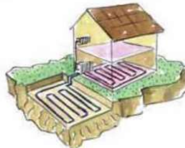
Capteurs horizontaux enterrés à environ un mètre
