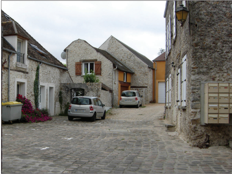
Cour dans le centre ancien rue du faubourg de Chartes. Au premier plan le pavage en grès a été conservé. A l'arrière plan, le sol en gravillon remplace le sol ancien dans la partie rénovée récemment.
