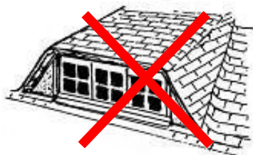
lucarne en trapèze ou rampante à jouées biaisées (couverture en bardeaux d'asphalte)
