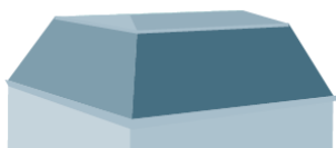
Toiture à la Mansart
