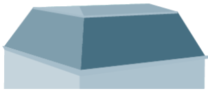
Toiture à la Mansart
