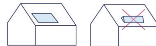
Privilégier l'encastrement des panneaux photovoltaïques
