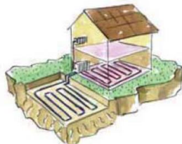
Capteurs horizontaux enterrés à environ un mètre
