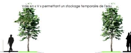
Voie en "V" permettant un stockage provisoire du ruissellement
