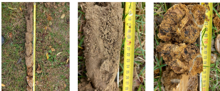
Profil typique de la catégorie Vb de la typologie GEPPA (hydromorphie de type rédoxique). À gauche : sondage n°4430 carottage complet ; au centre : segment 15-25 cm ; à droite : section à 70cm).
