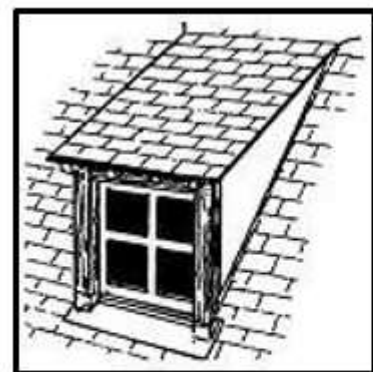
Lucarne rampante, dites en chien couché
