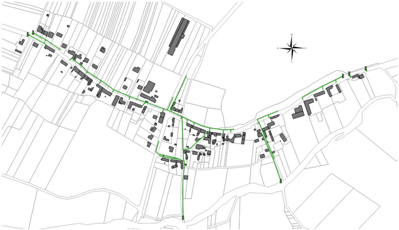
Figure 5 : Tracé du système de collecte EP – Les Baudières.
