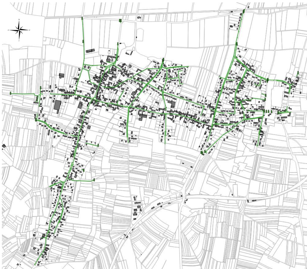
Figure 4 : Tracé du système de collecte EP – Centre-Bourg.
