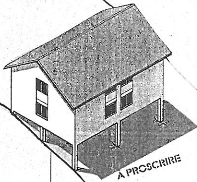
La construction sur pilotis est à bannir.
