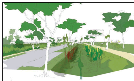
Exemple de noue végétale
