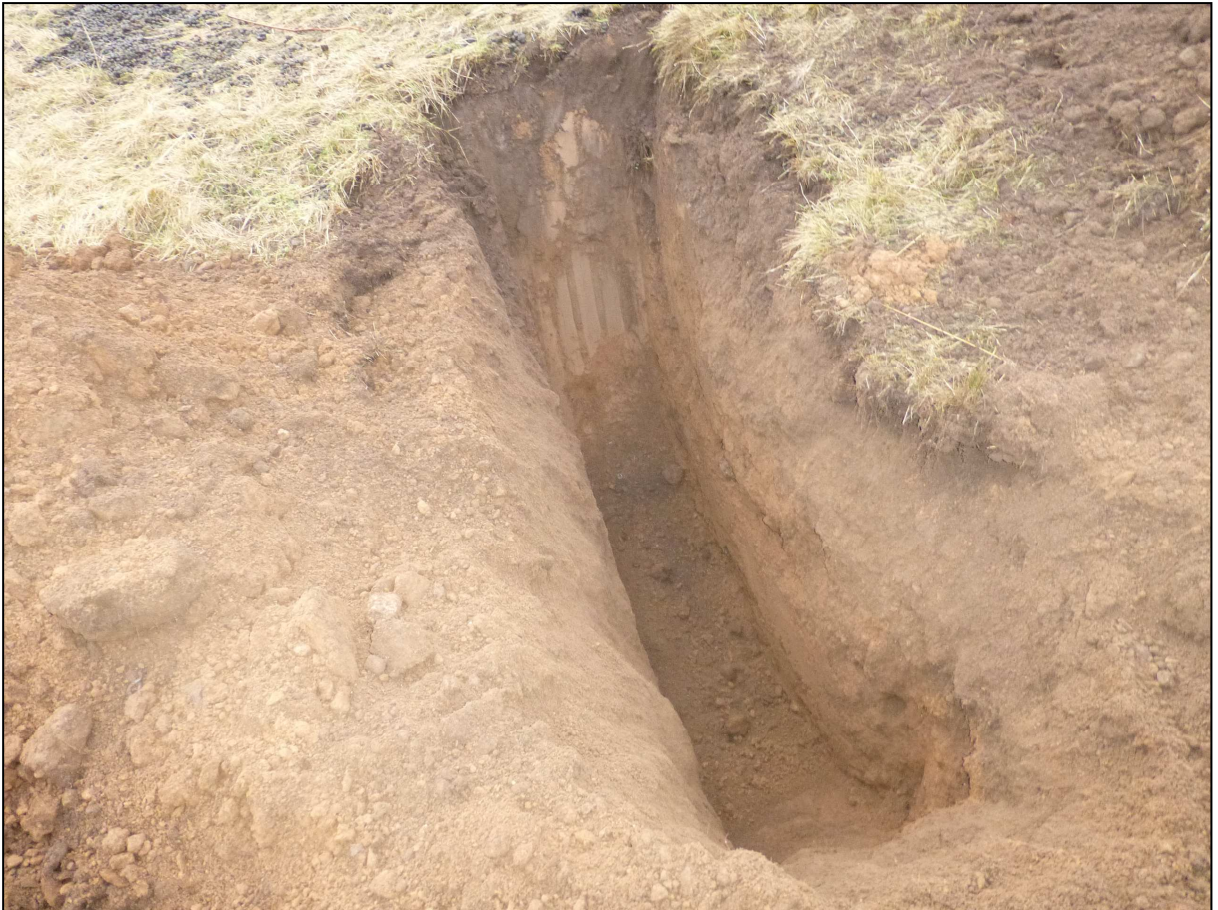
Sondage réalisé à la pelleuse : absence de tache hydromorphe
