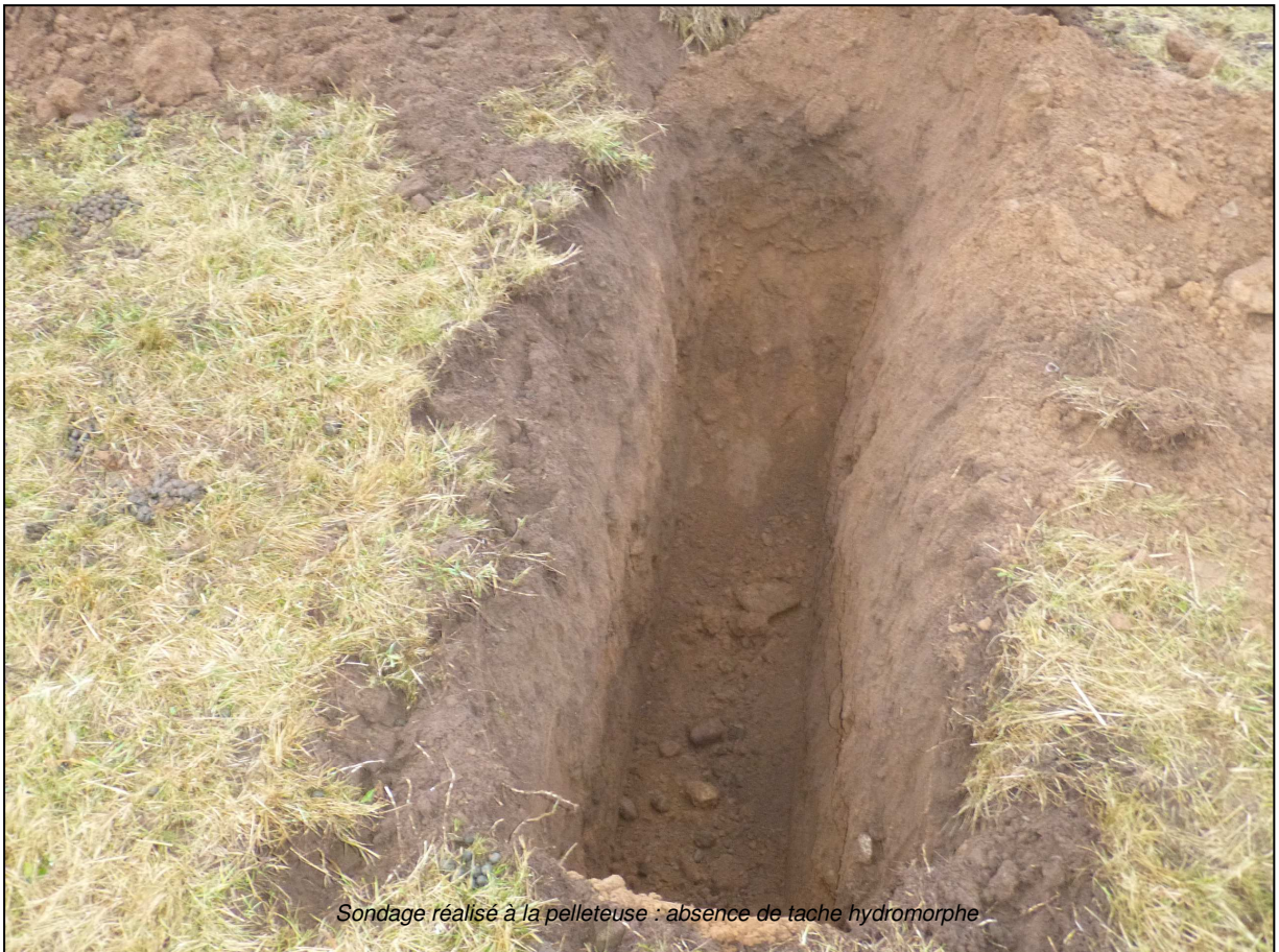
Sondage réalisé à la pelleuse : absence de tache hydromorphe
