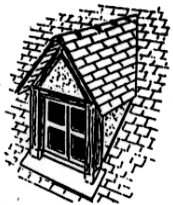
lucarne à deux pans dite jacobine, en bâtière ou à cheval
