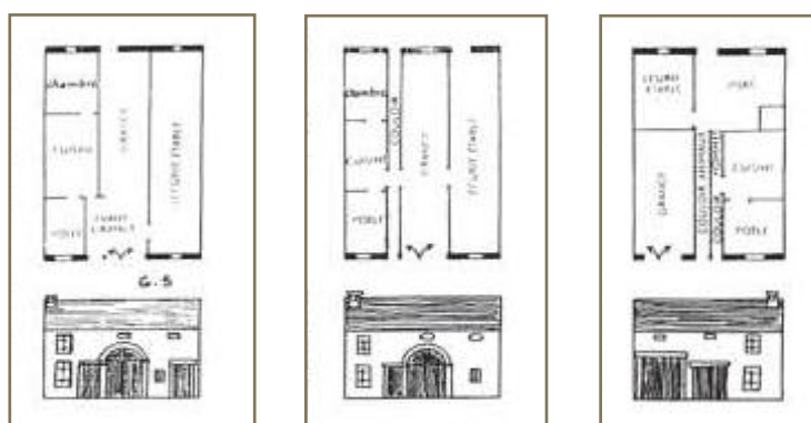
Dessins sur les typologies des fermes anciennes de la plaine des Vosges - extrait de l'ouvrage Vosges, encyclopédies régionales - éditions C. BONNETON - 1987
