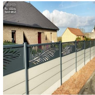
Dispositif à claire voie mais avec un mur bahut supérieur à 80 cm de haut.
