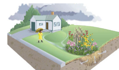
Schéma d'un jardin de pluie (source : SIARE, 95)
