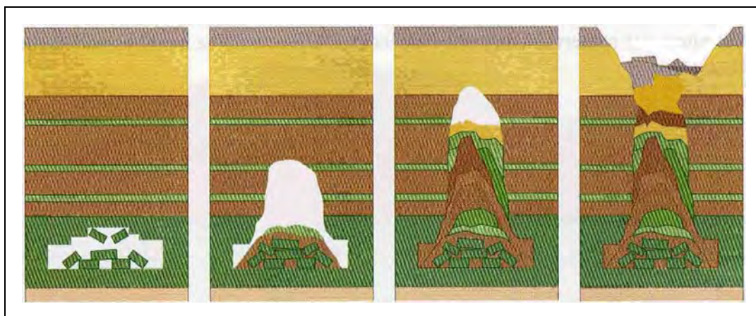
Figure 14 : Schéma de principe d'évolution d'un effondrement localisé (d'après Évaluation des Aléas liés aux Cavités Souterraines – LCPC, 2002).
