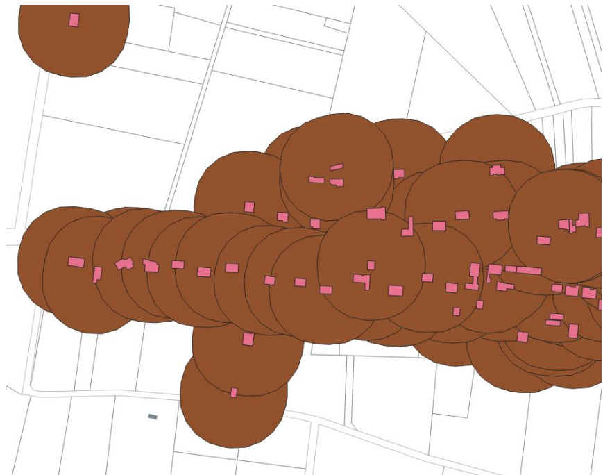
Etape 2 : tampon de 50m autour des bâtiments de 50m 2
