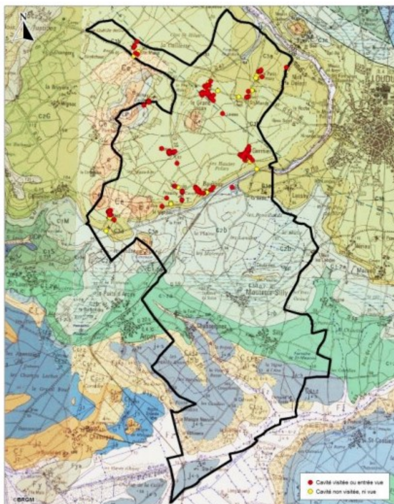
Figure 69. Recensement des cavités à Mouterre-Silly (Source : BRGM)
