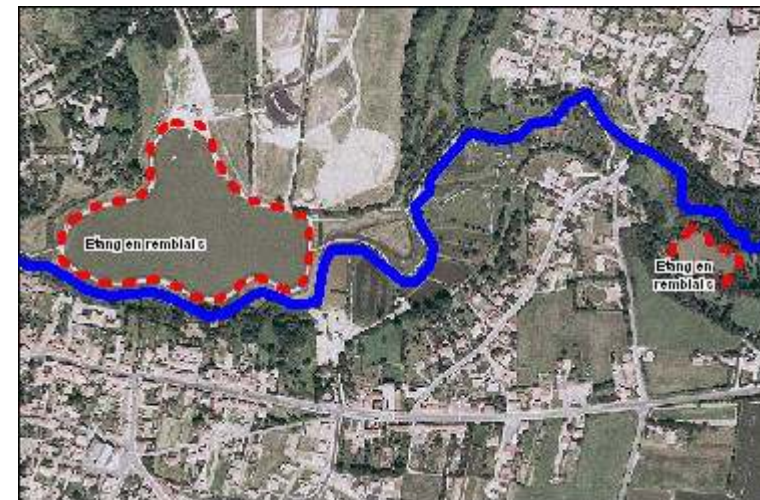
Photo 1: étangs en remblai dans le lit majeur à l'amont de Talmont-Saint-Hilaire
