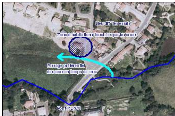
Photo 6: Vue aérienne des habitations inondables
