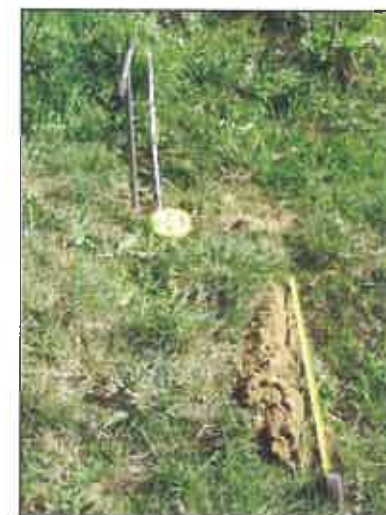
Matériel utilisé pour les inventaires de terrain : tarière, mètre, décimètre.
