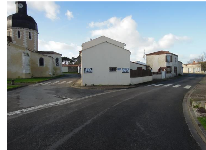
Centre ancien : maison de bourg (alignement sur rue, mitoyenneté, deux niveau en RdC + 1 étage, parcelle de petite taille)
