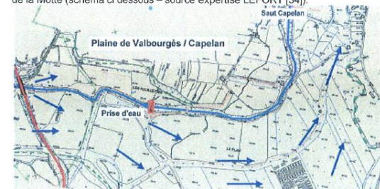
Figure 11 : Schéma des écoulements débordants dans la plaine à Valbourgès (source expertise post crue Lefort)
