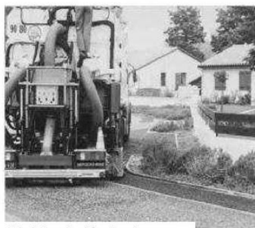
Machine de décolmatage. Source CETE du Sud-Ouest
