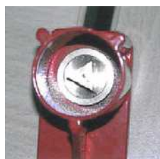
Ouverture du cadenas avec clé tricoise des sapeurs-pompiers
