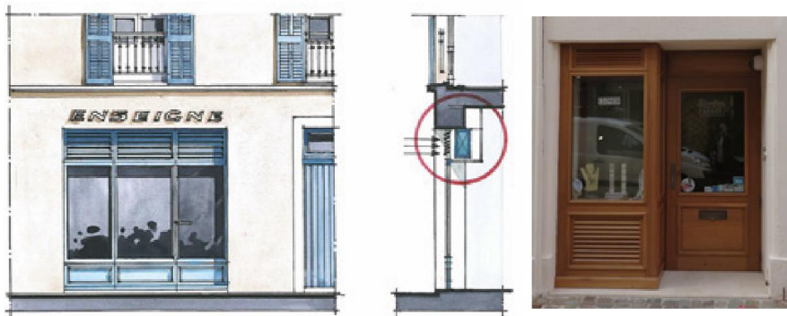
Climatiseur posé à l'arrière de l'imposte
