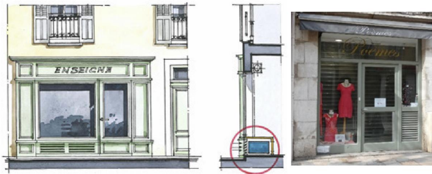
Climatiseur posé à l'arrière du soubassement
