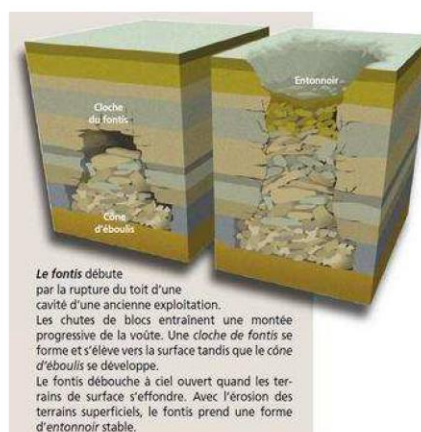
Illustration du phénomène d'effondrement localisé
