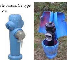
Poteaux d'aspiration de 100 mm à réseau sec, munis d'une seule sortie de 100 mm. Pas de volant ni de carré de manœuvre.
