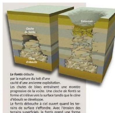
Illustration du phénomène d'effondrement localisé
