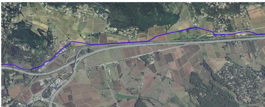
Réseau d'irrigation de la SCP // Source : Société du Canal de Provence Le réseau reste cependant très peu utilisé, du fait des faibles disponibilités en ressources et des pressions limitées. Une liaison Verdon - Saint Cassien est en cours de réalisation.
