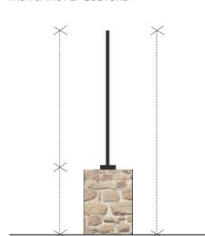
MUR BAHUT ET CLÔTURE
