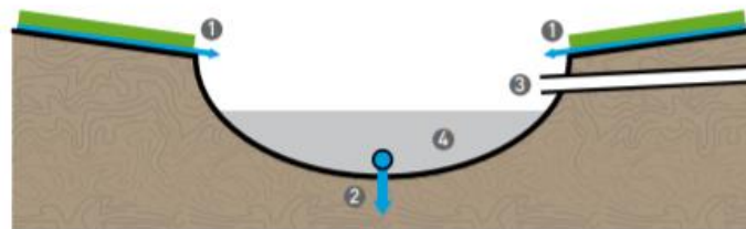
Noue de rétention
