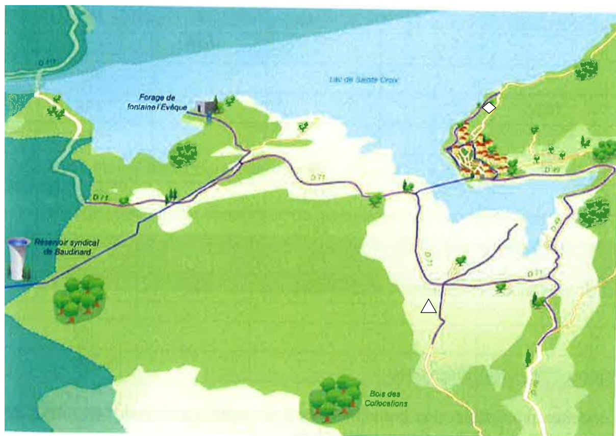
Schéma synoptique du réseau d'alimentation en eau potable de la commune de Bauduen
