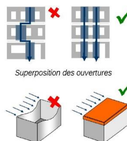
Limitation des déformations : effet «boîte»
