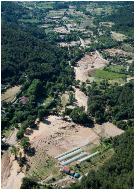
Photos 74 : La Nartuby en amont du seuil de la Clappe – divagation vers le lit majeur droit- Post Crue
