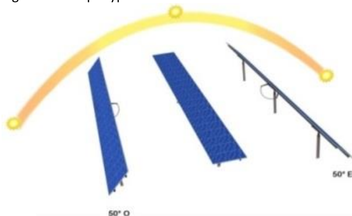
Figure 8 – schéma de fonctionnement des structures trackers
