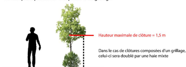
Clôture principalement composée d'un grillage
