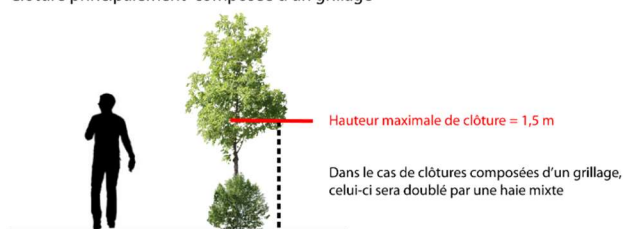
Clôture principalement composée d'un grillage
