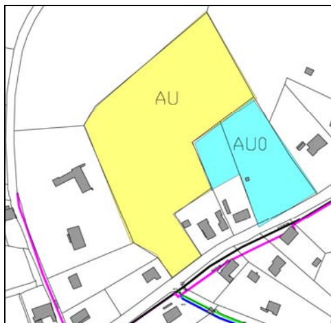
Zone AU et AU0 des Doublettes Canalisation diamètre 150 mm (noir) / 60-75mm (rose) 110mm (vert) et 50mm (bleu)
