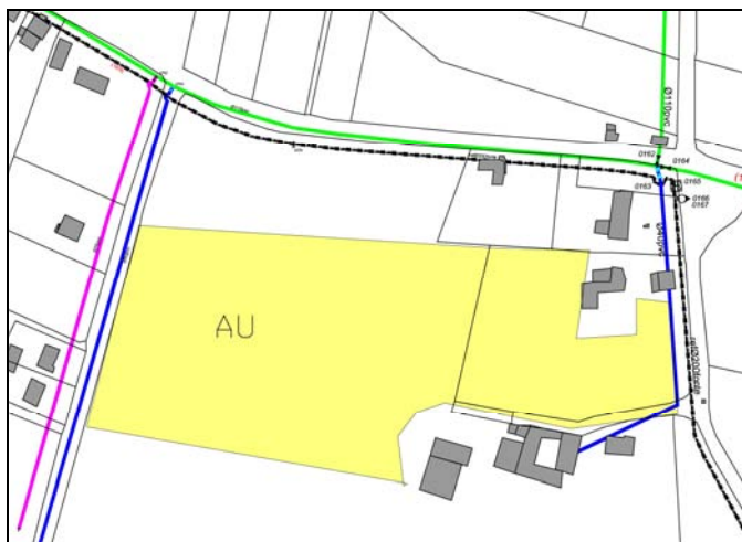
Zone AU de la Paillassarie Canalisation diamètre 200 mm (noir) / 75mm (rose) 110mm (vert) et 50-40mm (bleu)
