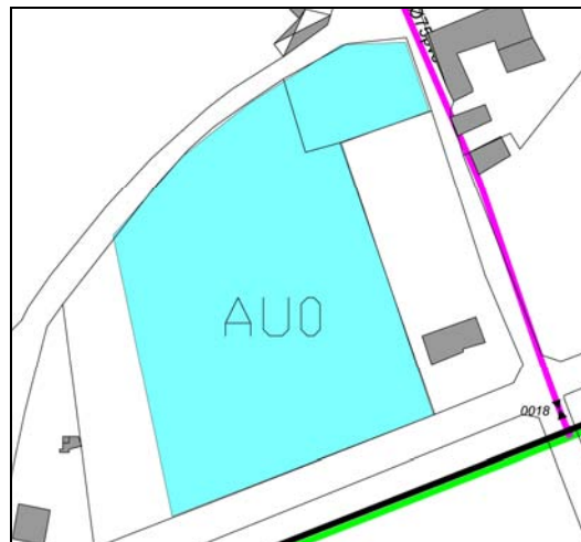
Zone AUO des Bascagnes Canalisation diamètre 200 mm (noir) / 75mm (rose) 110mm (vert)
