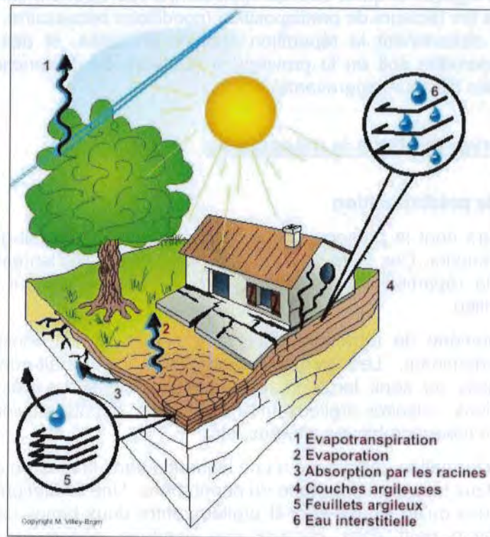
fig. 1 : illustration du mécanisme de dessiccation
